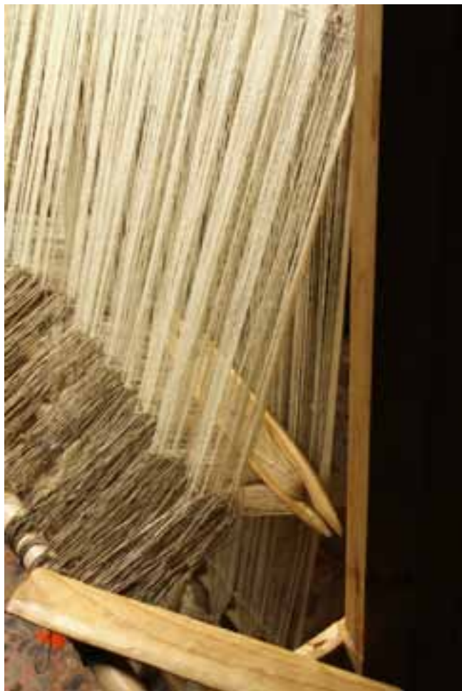
Espacio entre los hilos pares e impares para pasar el hilo de la trama. En este caso solo se ha tejido 10 cm y ya empieza a reducirse el espacio
